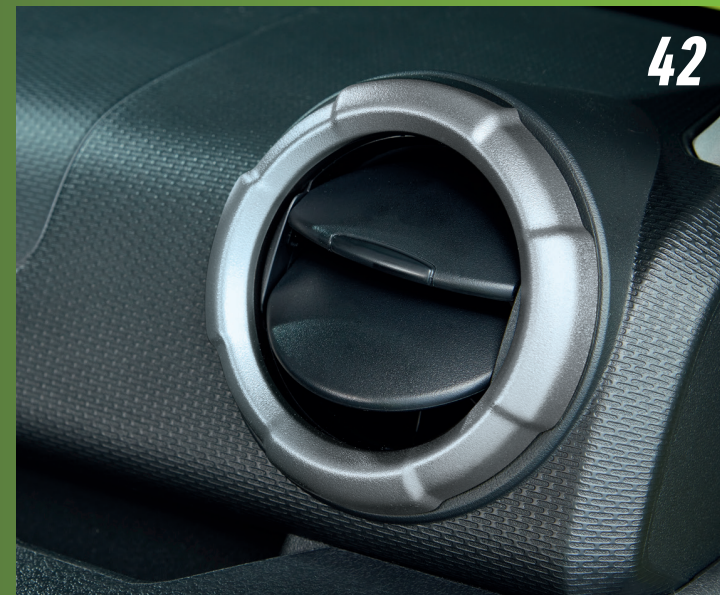
42 - Ventilador de aire acondicionado
